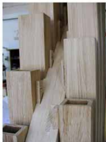
Anhängung der Holzpfeifen (über Holzkeile)
