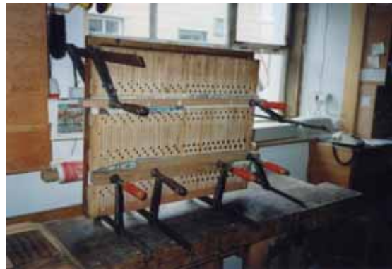
Hauptwerkwindlade – während der Renovierungsarbeiten in der Werkstatt
