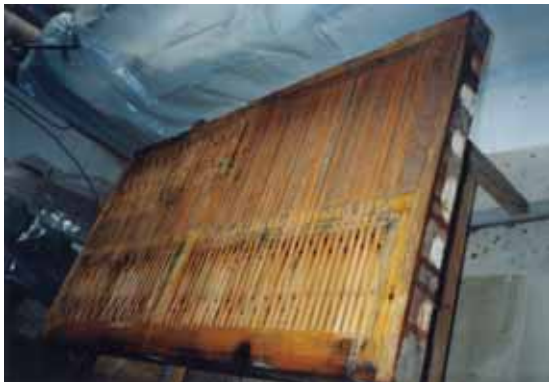
Hauptwerkwindlade – während der Renovierungsarbeiten in der Werkstatt
