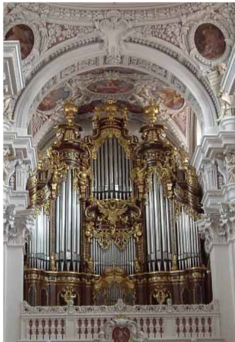
Die größte Orgel Europas steht im Dom zu Passau. Sie wurde in den Jahren 1924 bis 1928 erbaut und zwischen 1978 bis 1981 neu gestaltet. In 5 Orgelwerken sind insgesamt 17.774 Pfeifen und 229 Register zu finden. Die größte Orgelpfeife ist stolze 11 Meter hoch
