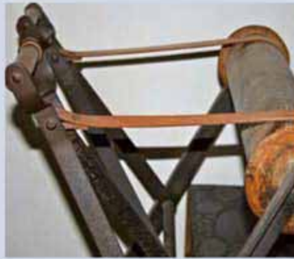
Historische Hebel und Lederriemen zur Keilbalgbetätigung
