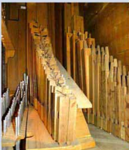
Das Pfeifenwerk: Prinzipal 2' (ganz links), Mixtur 2f., Flöte 4', Coppel 8'
