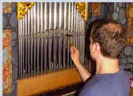
Korrekturen an den Labien der Prospektpfeifen
