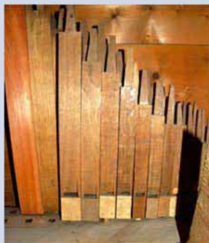
Register Coppel 8' mit vierkantig-pyramidalen Spunden
