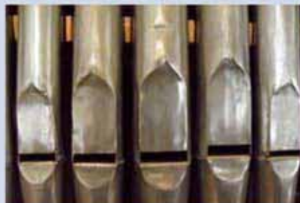
Prospektpfeifen (Prinzipal 2') aus Zinn: Oberlabium mit gotischen Spitzbogen („Eselsrücken“), Aufschnitt (Schall-Loch) und Unterlabien
